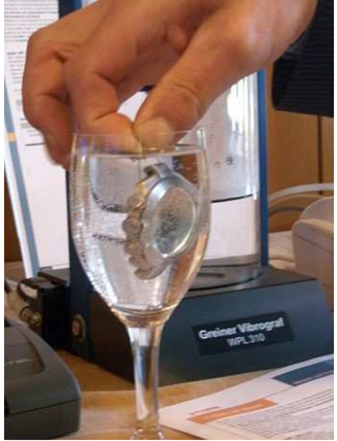
Wasserdichtheit und Lecksuche
