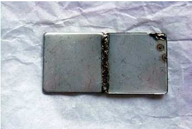
Ergebnis einer PUK Schweißung
